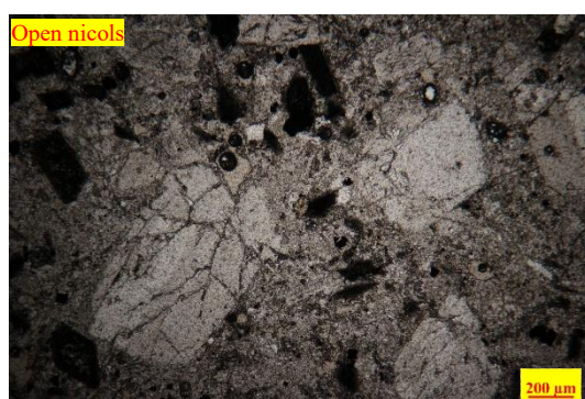
圖 A-3. 基隆嶼石英安山岩斜長石、輝石之薄片照片。
