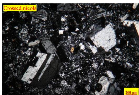
圖 A-3. 基隆嶼石英安山岩斜長石、輝石之薄片照片。
