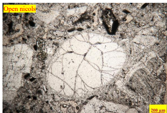
圖 A-4. 基隆嶼石英安山岩石英之薄片照片。
