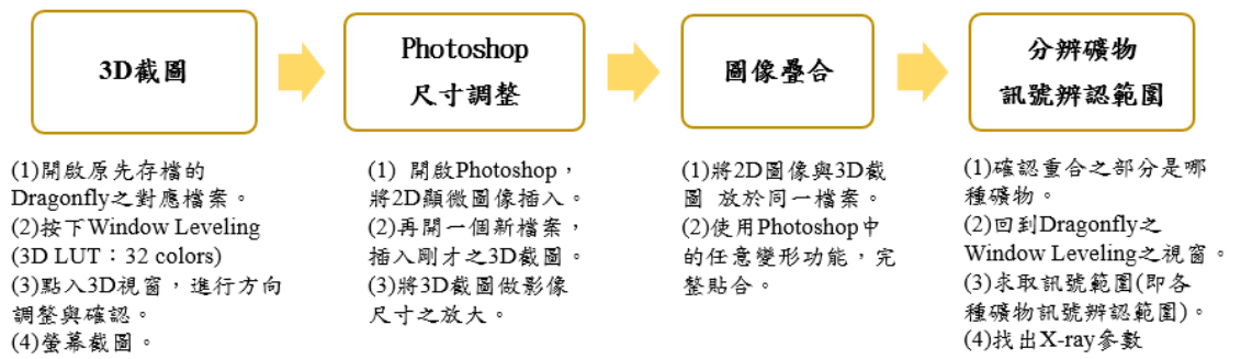
圖 10、2D 圖像與 3D 模型之整合之詳細流程整合圖：依照研究步驟中的分辨礦物進行操作，即可得到分辨礦物與訊號辨認範圍之結果。
