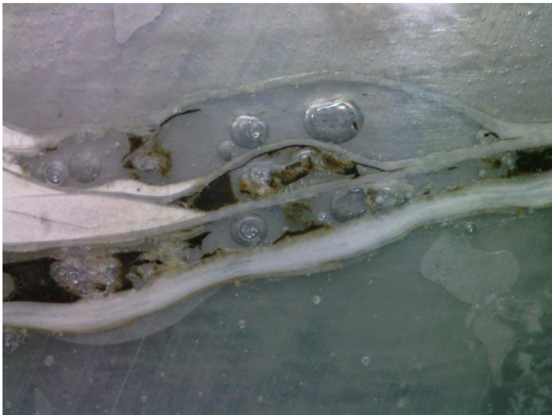
圖七、黑色部分為堆積在空腔裡的沉積物，在磨製薄片時沒控制好，導致大部分沉積物被移除。也可以明顯看出空腔裡有許多大小氣泡。
